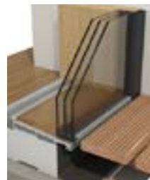
PANORAMA FIKSEERITUD KLAASPAKETT ohutuse tagamiseks on soovitatav kasutada turvaklaasi (lamineeritud või karastatud)
