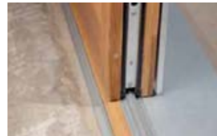
KLAASKIUD LÄVEPAKK klaaskiud lävepakk soojusisolatsiooniga vahetükkidega ja 5 mm juhtsiiniga tasandusplaadiga, mis tagab nii seestpoolt kui ka väljaspoolt ideaalse tasanduse põrandaga, lävepaku laius 240 mm kõrgus 42 mm
